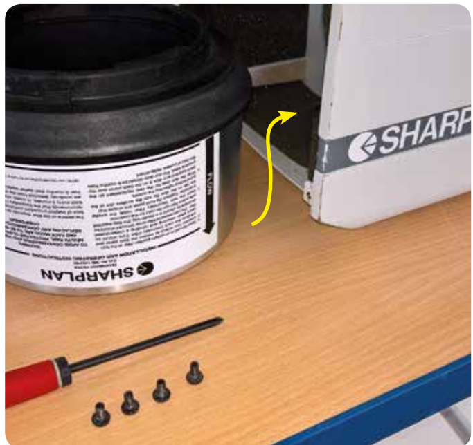
Montez le filtre et placez le capot. Monteer de nieuwe filter en plaats de afdekplaat.
