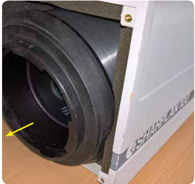
Retirer le filtre usagé. Verwijder de gebruikte filter.
