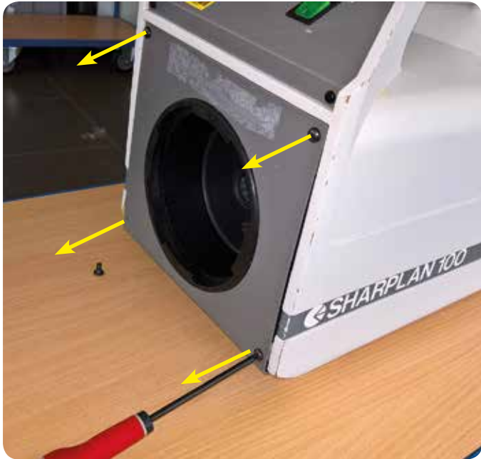
Dévisser les 4 vis pour enlever le capot. Maak de 4 schroeven los en verwijder de afdekplaat.
